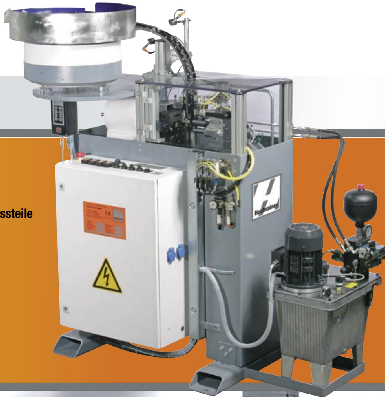
Mit diesem Automat können gepresste, gegossene oder gestanzte Teile fertig bearbeitet werden (beispielsweise Innengewinde oder Formdrehen). Die Zuführung der Rohlinge kann manuell, automatisch, oder durch einen Roboter erfolgen.
