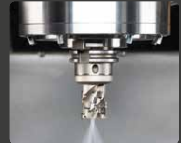
Kühlluft durch Spindel
