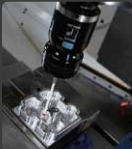
Werkstücklageerkennung mit Taster
