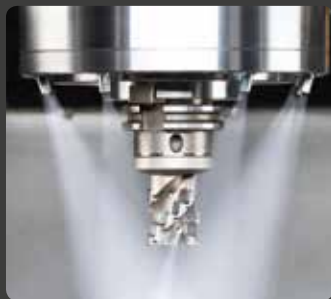
Kühlluft über Düsen
