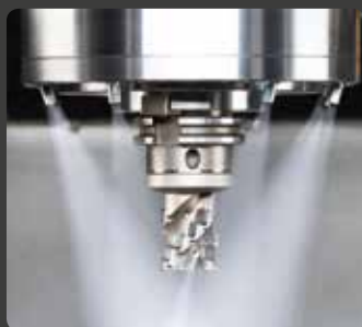
Kühlluft über Düsen
