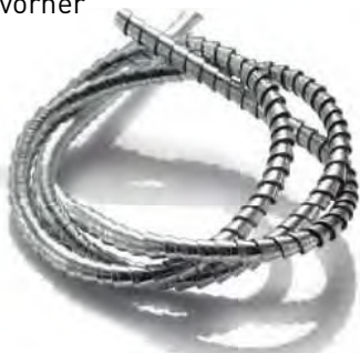
Spanbildung mit herkömmlicher Bearbeitung
