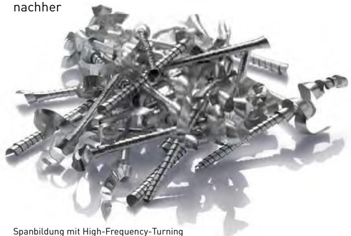
Spanbildung mit High-Frequency-Turning
