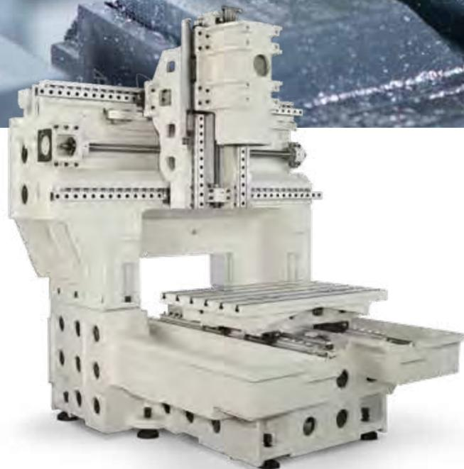
Die Portalbauweise der Takumi Bearbeitungszentren garantiert höchste Präzision – Werkstück für Werkstück.
